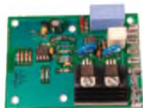
Печатная плата для плавного пуска однофазного электродвигателя
