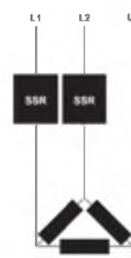
Двухфазное ТТР SOB для контроля нагревательных элементов, соединенных треугольником (для сбалансированных или несбалансированных нагрузок высокого напряжения)
